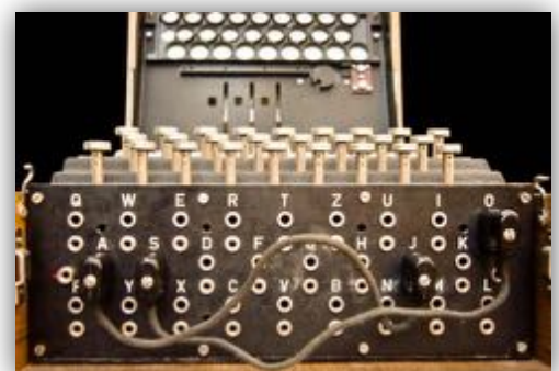
Figura 3 – Pannello dei collegamenti di una macchina Enigma.
